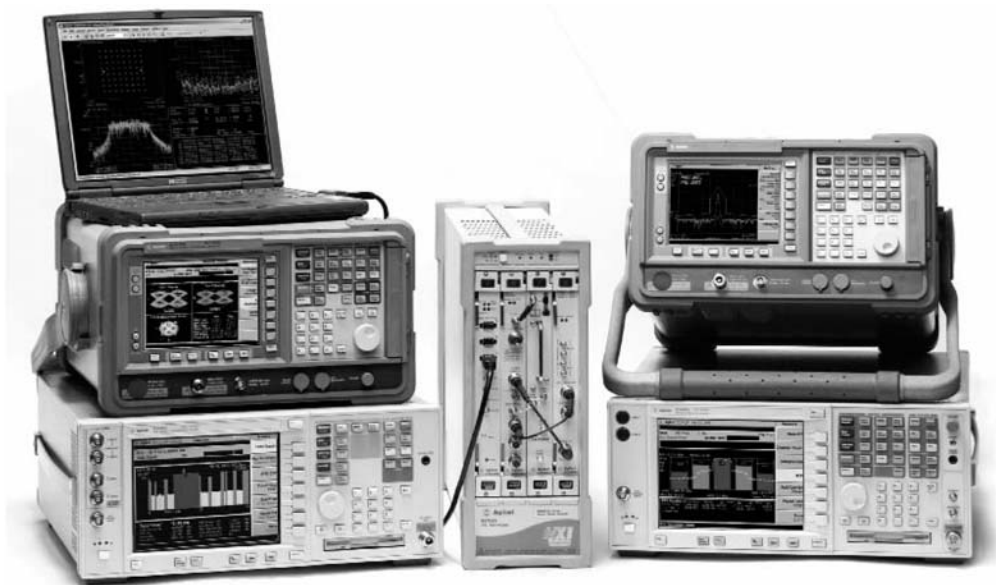
Анализатор сигналов, образованный объединением отдельных приборов с помощью программы Agilent 89601A
